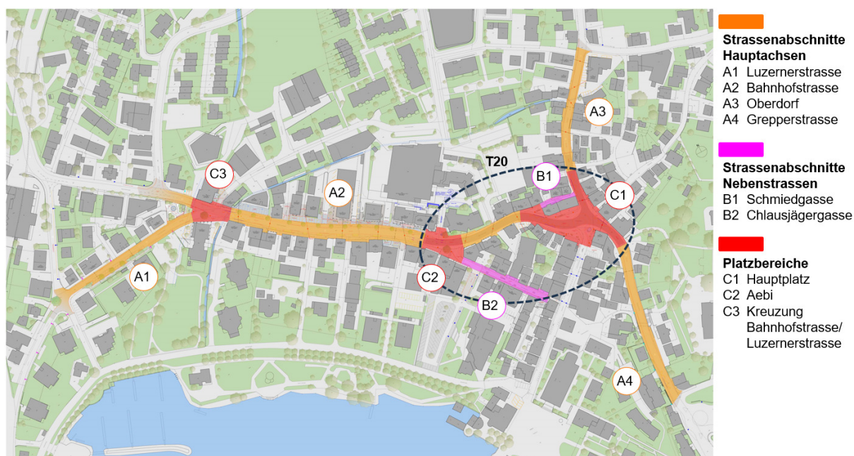
Abb. 1: Unterteilen der Beleuchtung im Projektperimeter in Strassen- und Platzbereiche
