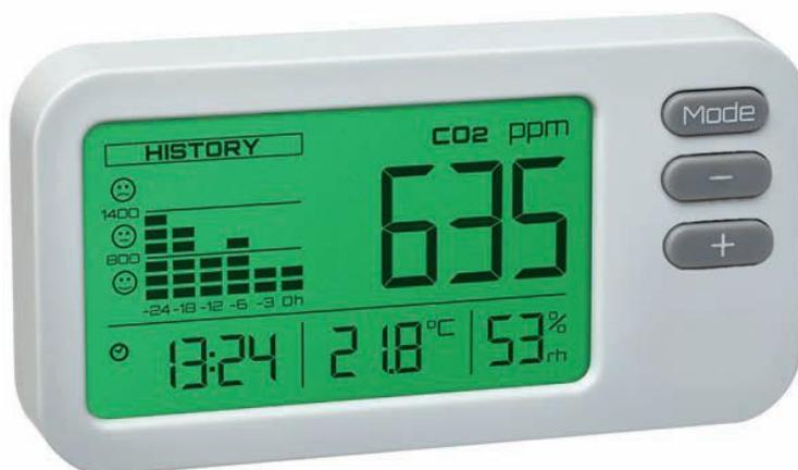
CO<sub>2</sub>-Messgeräte zeigen, ob gelüftet werden muss.
